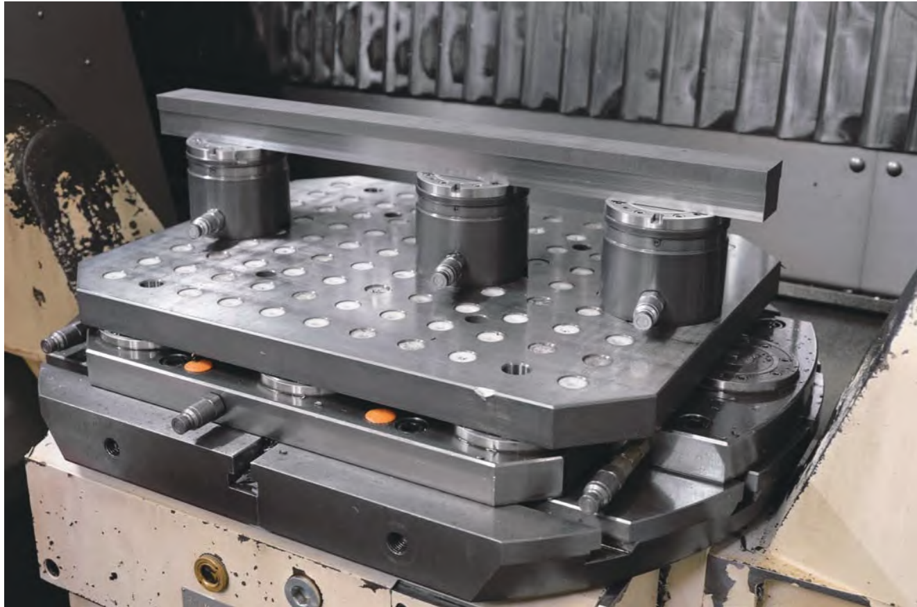
依托模块化零点定位技术，实现五面加工的最佳可达性。
