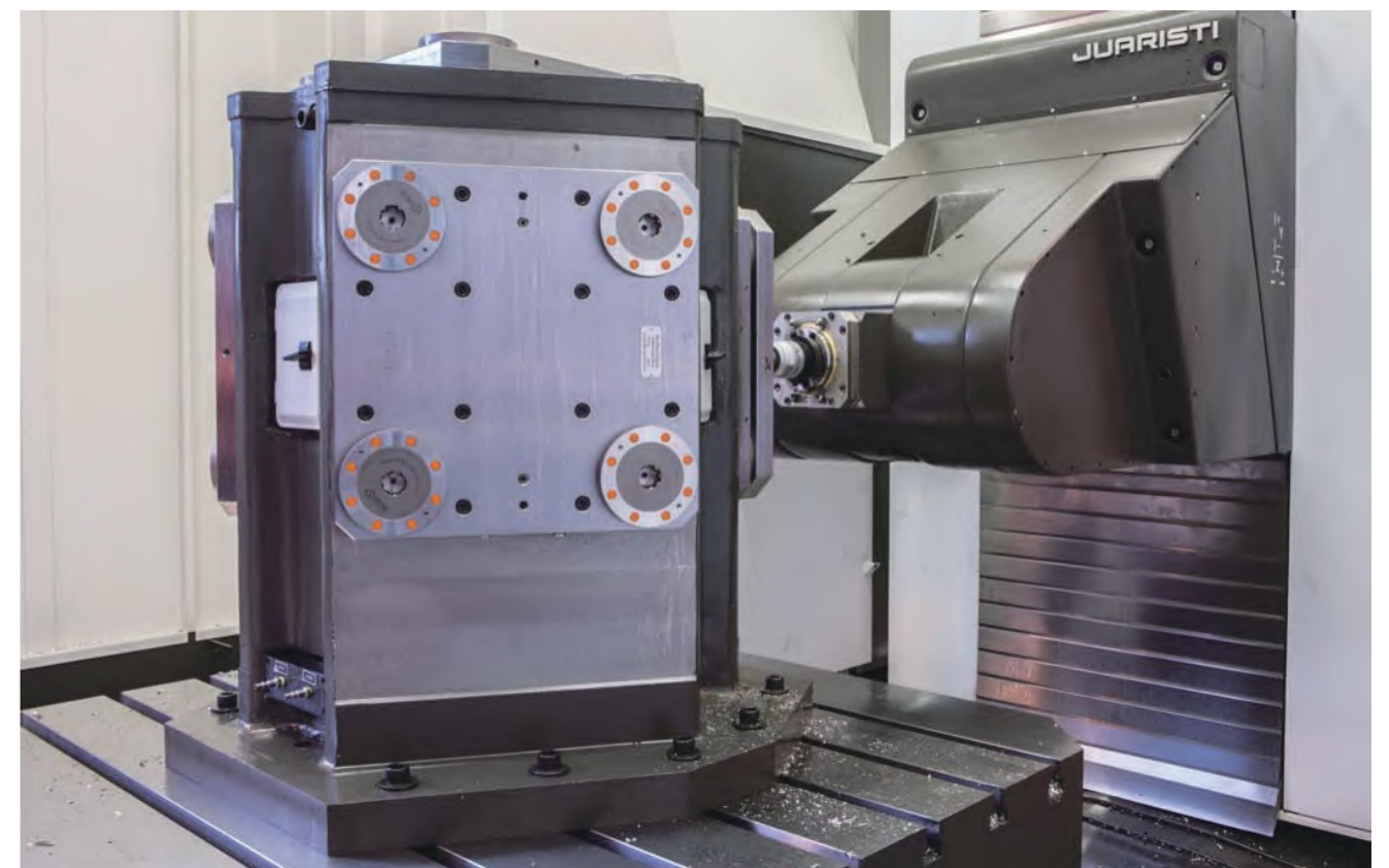
AMF英世齐零点定位系统在不利受力条件（力臂较大）下的钻削加工中，依然具备可靠的夹紧性能。 即便面对高切削参数与复杂工件，也能确保加工过程稳定可靠。
