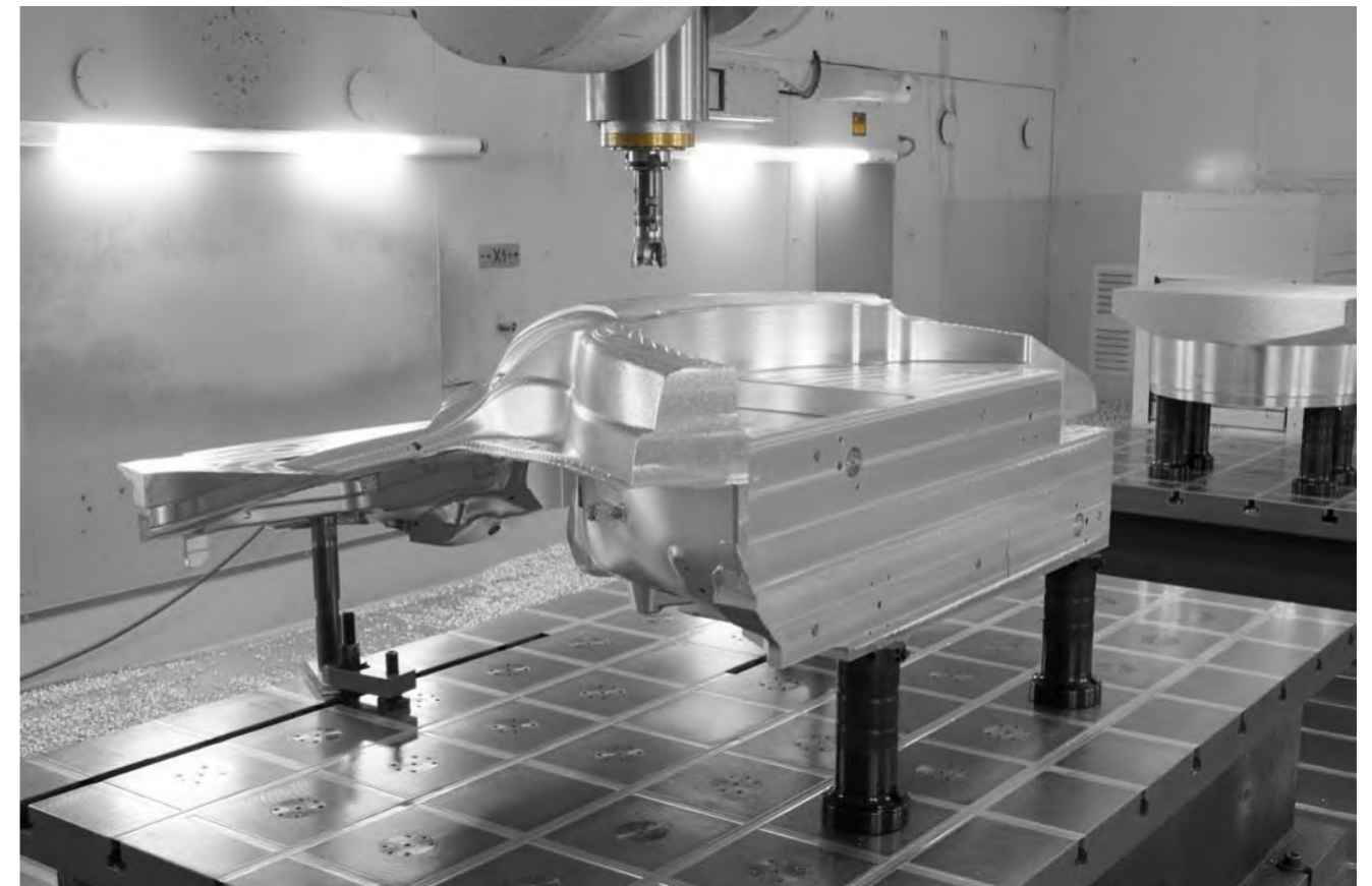
针对大型铝制工件, 可实现直接装夹。通过在工作台集成零点定位模块, 并配合模块化连接与中间过渡元件, 构建灵活高效的装夹方案。
