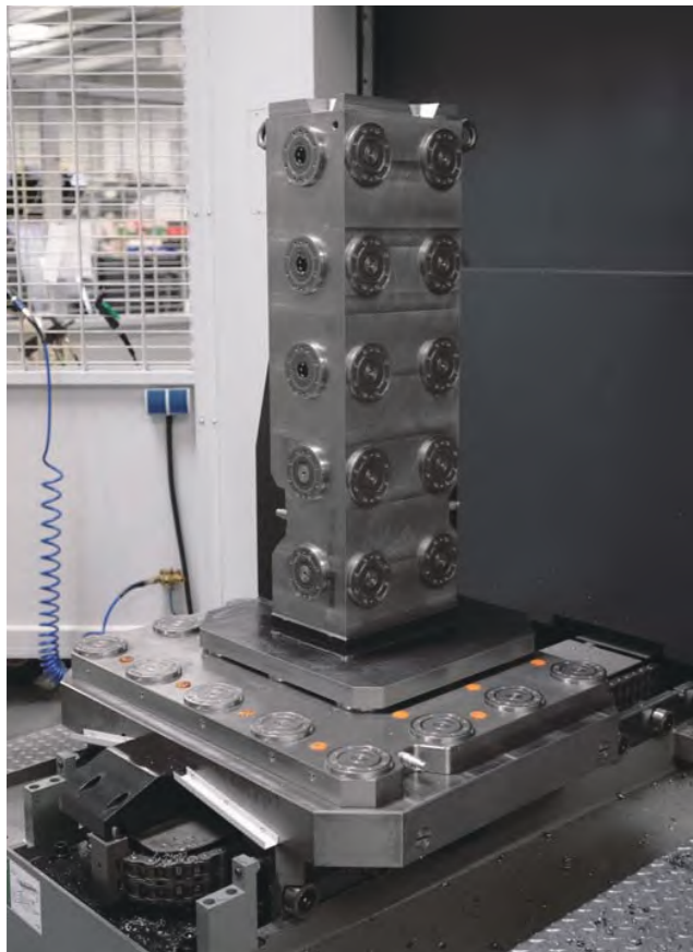
依托模块化零点定位技术，实现五面加工的最佳可达性。
