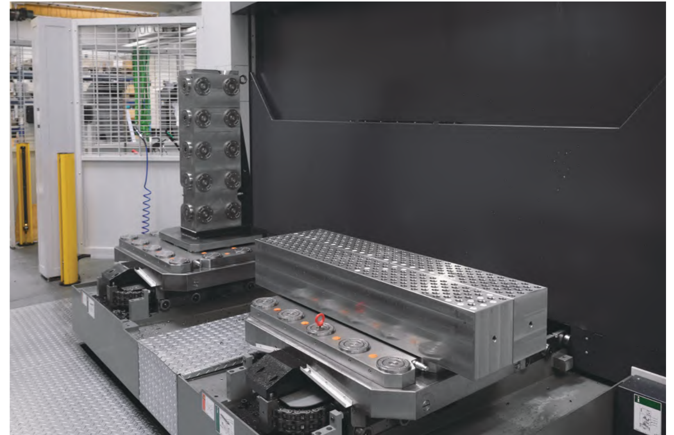
AMF零点定位系统用于深孔加工
