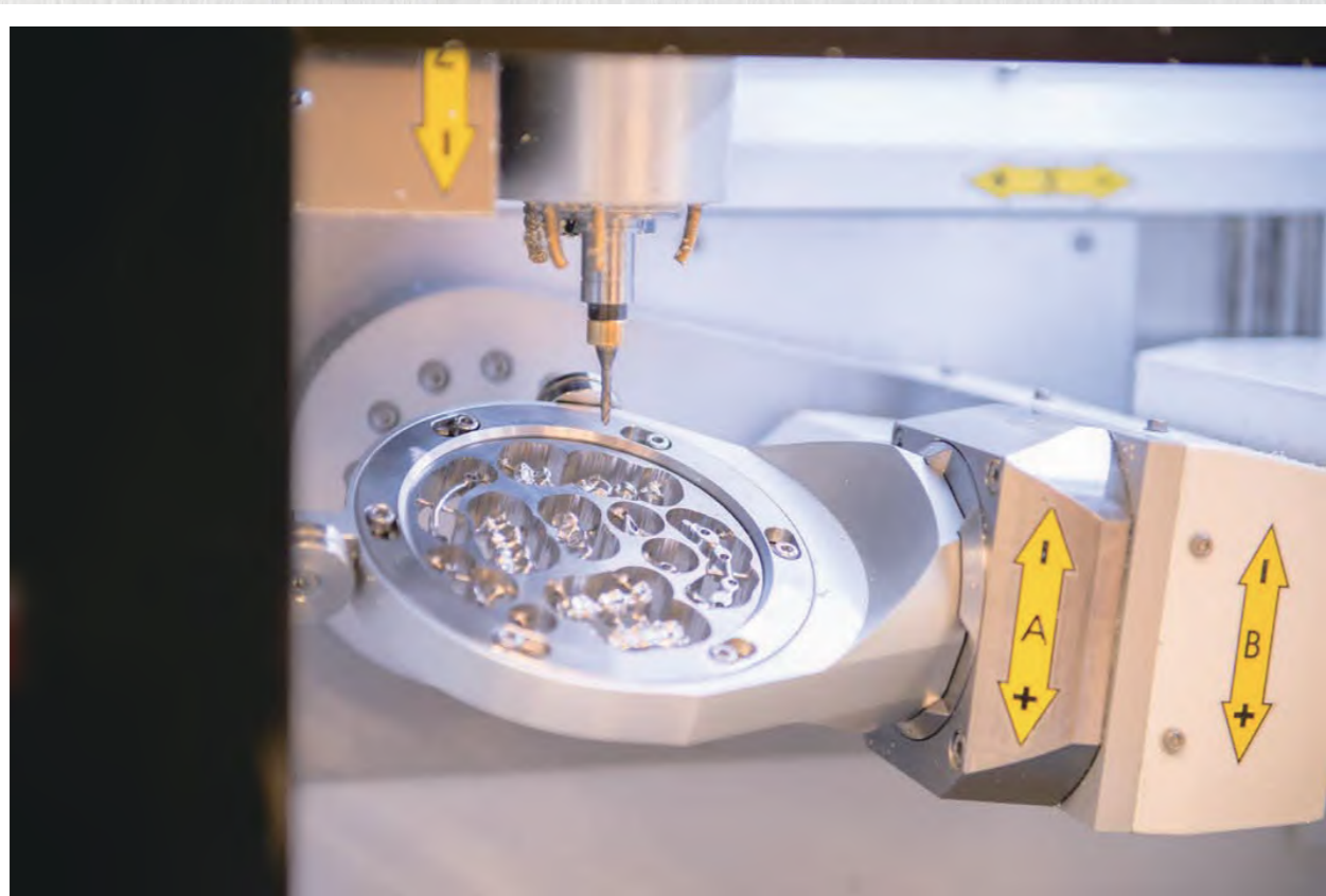
加工钛合金牙齿的全自动生产线
