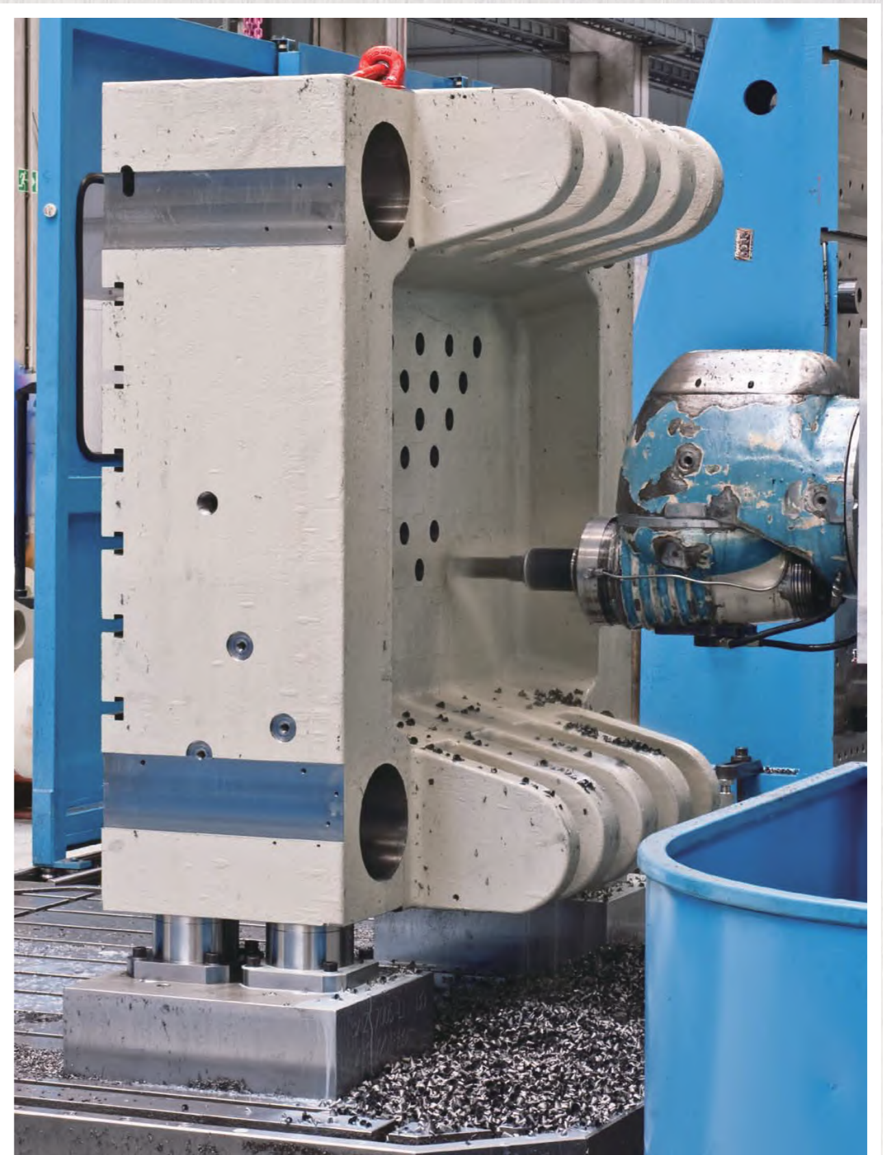
AMF零点定位系统用于重型零件加工
