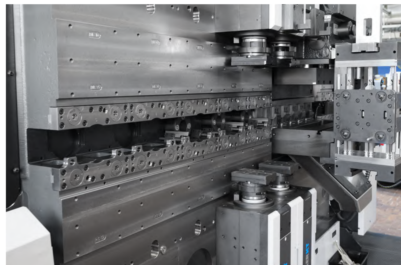
AMF零点定位系统快速更换模具
