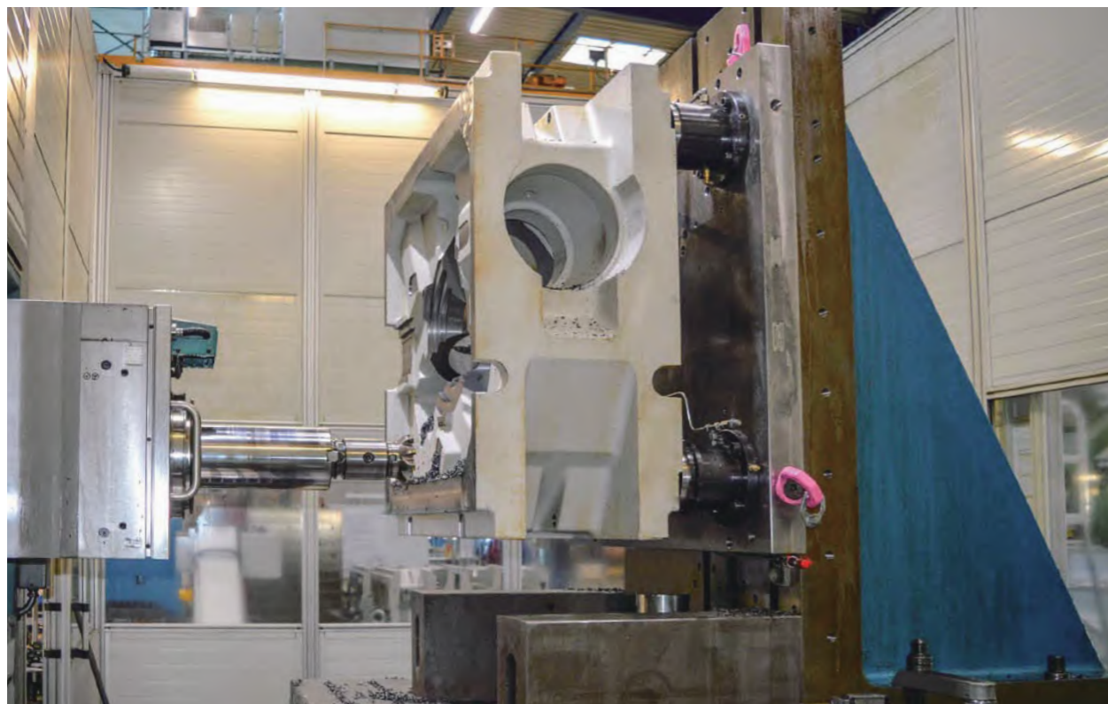
在卧式加工中心中直接装夹零件，其中两个零点定位系统可在高度方向浮动，降低了对零件精度的要求。
