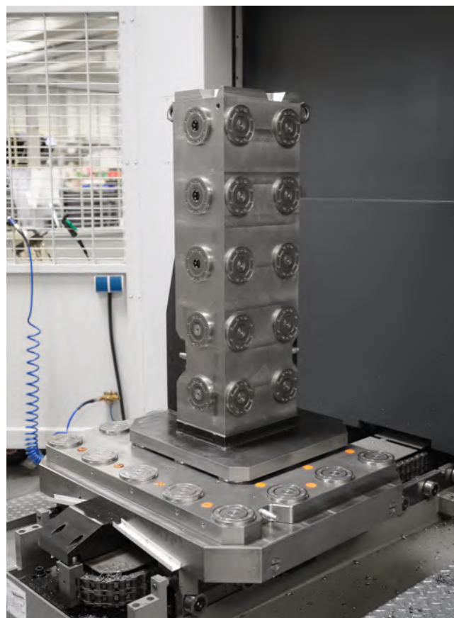
AMF零点定位系统实现五面加工
