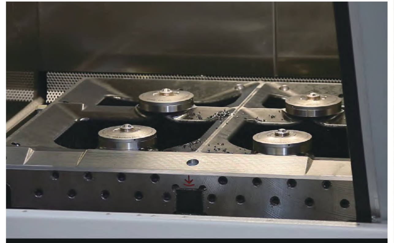
全自动化涡轮吹屑型零点定位工作台
