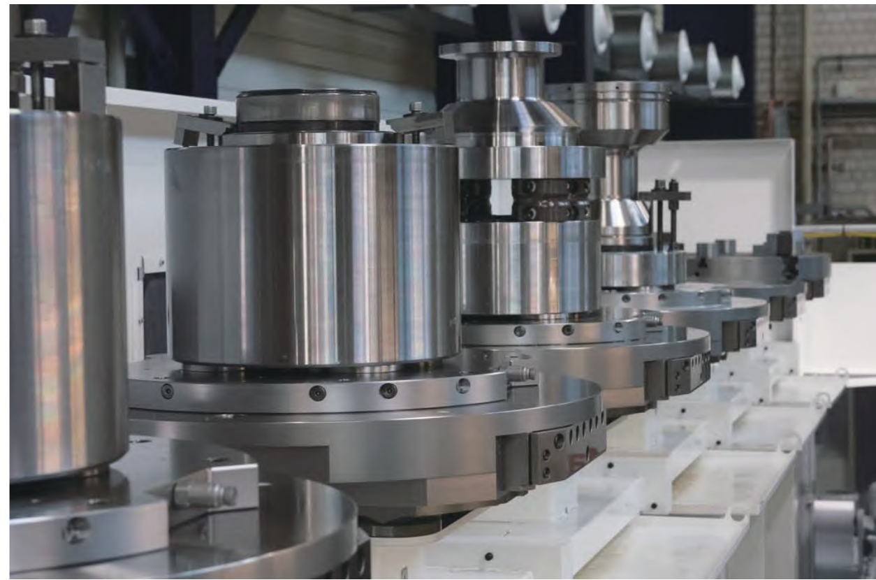
AMF零点定位系统作为快换托盘系统用于铣削-磨削加工中心
