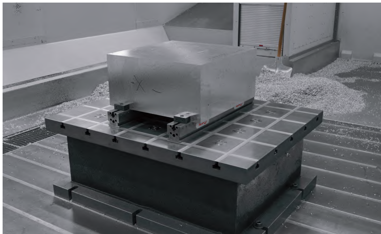
通过AMF零点夹紧技术，可最大限度的降低安装时间。
