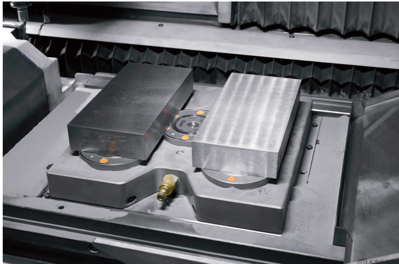
AMF零点定位系统在增材制造（3D打印）中的使用。 5单元零点定位基板在混合机器上快速更换托板。（SLS/HSM）
