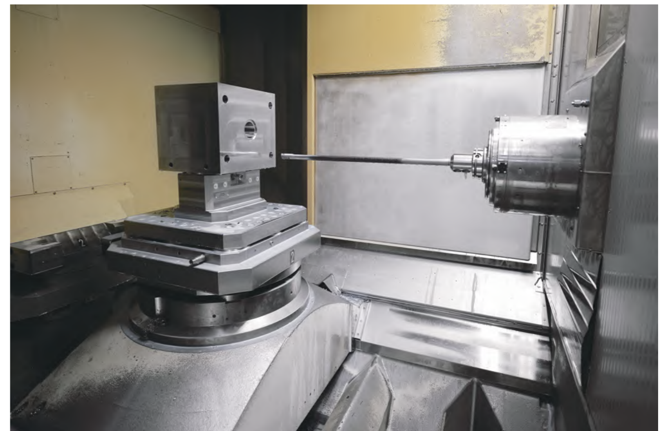
AMF零点定位系统用于深孔加工
