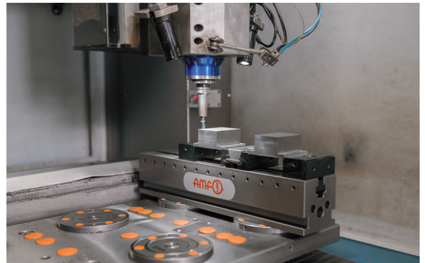
AMF零点定位系统与夹持系统配合使用。
