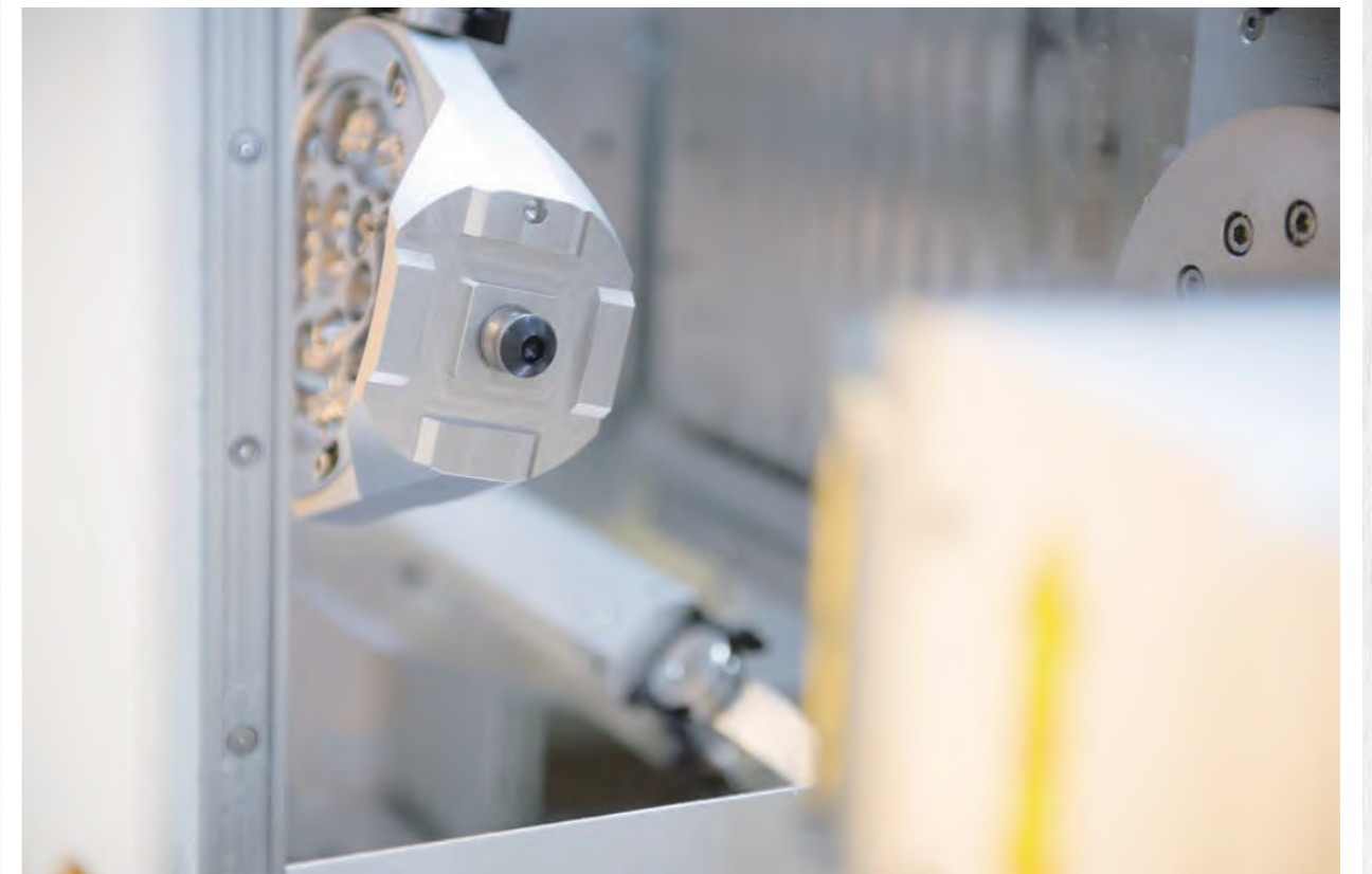
零点系统是就机床工作台及工装夹具之间的标准接口
