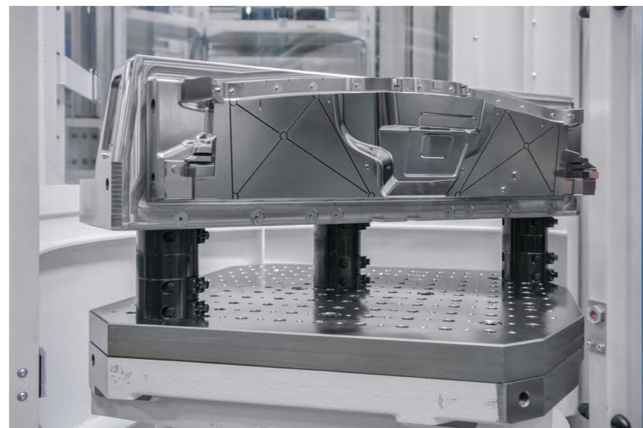
手动零点定位在模具行业中的应用。使用标准化的结构套件可实现不同高度的夹紧。
