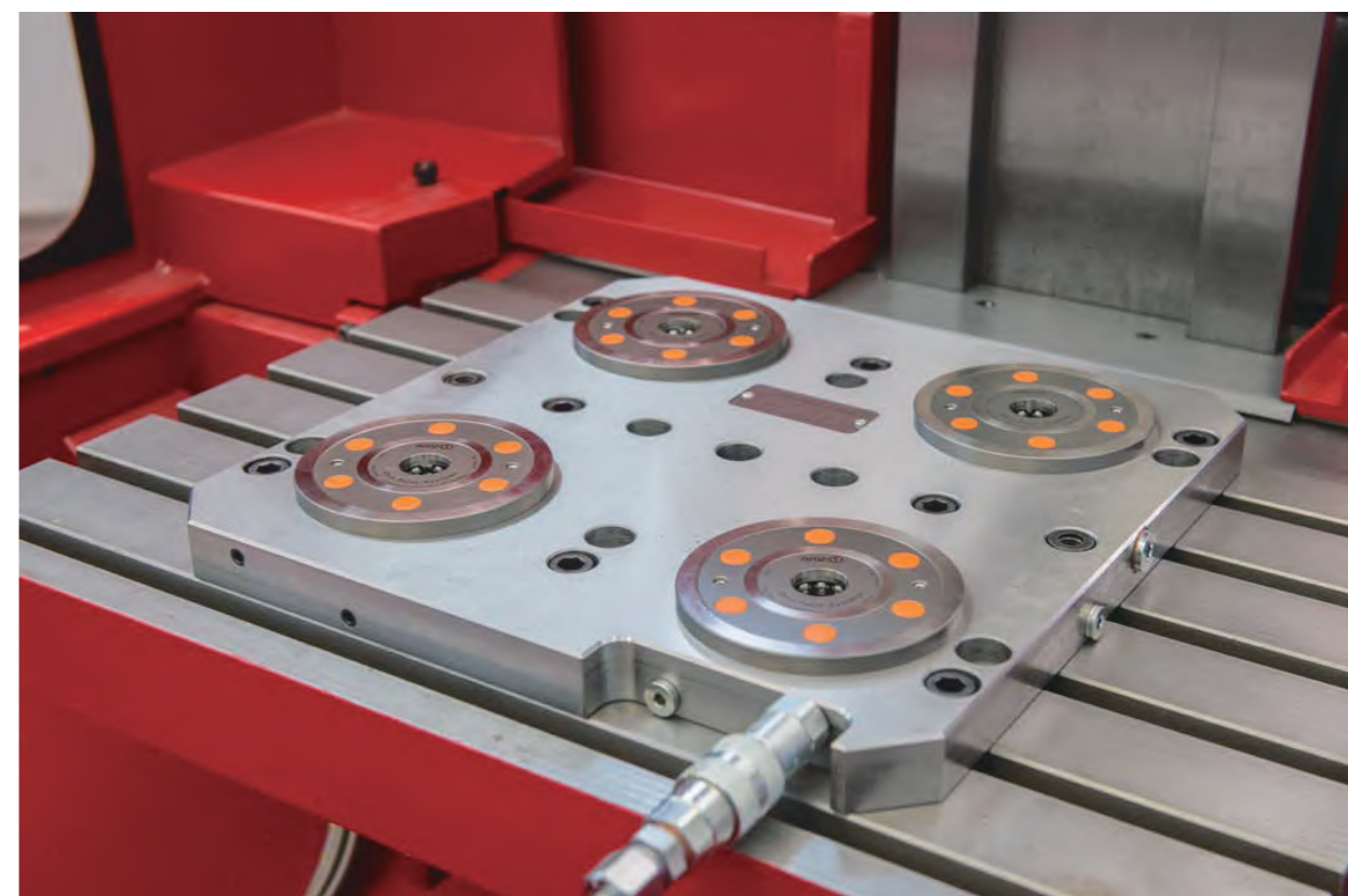
零点定位系统将不同设备接口统一化
