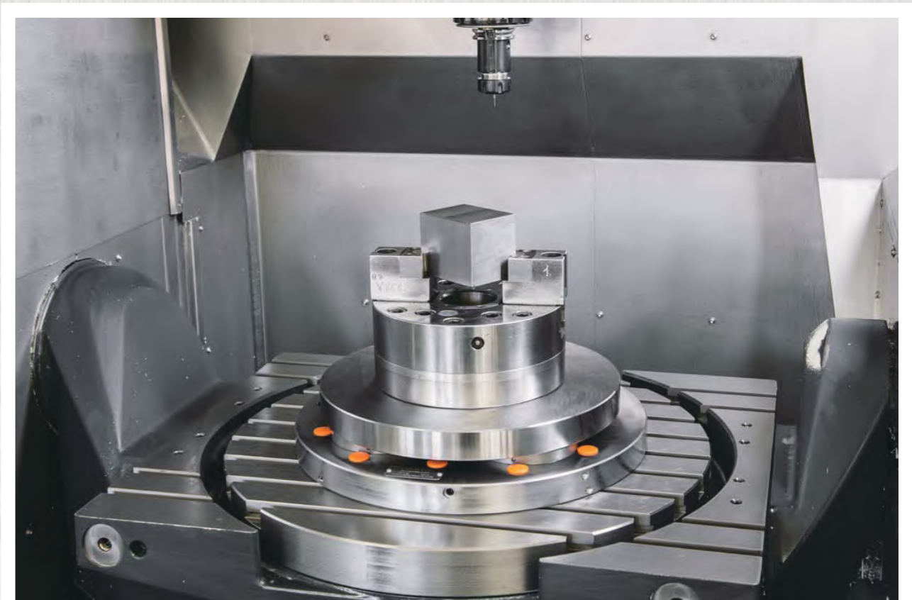
四单元零点定位系统用于五轴加工中心，最大转速可达2200rpm。
