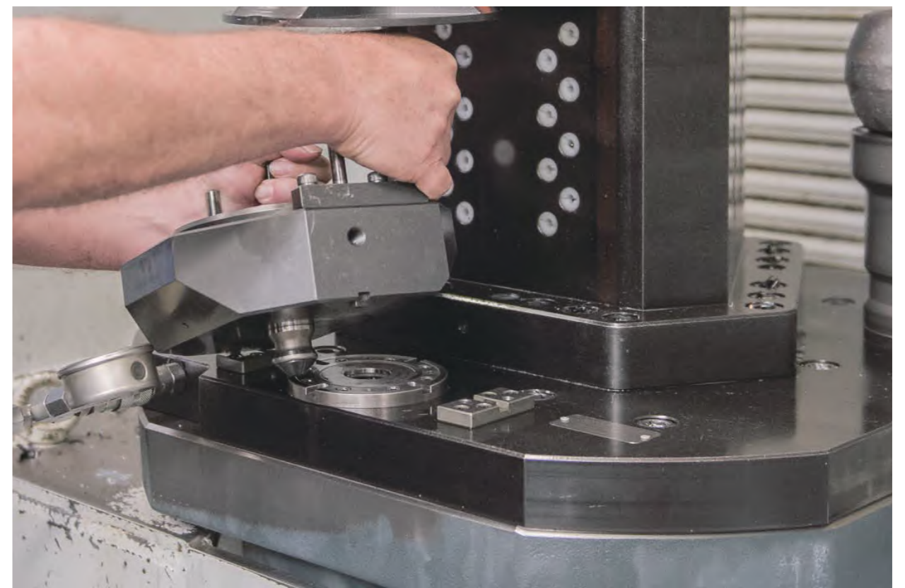
这种组合使客户可以在一个夹具上面夹持不同的部件，同时还可以通过更改实现对新产品的装夹
