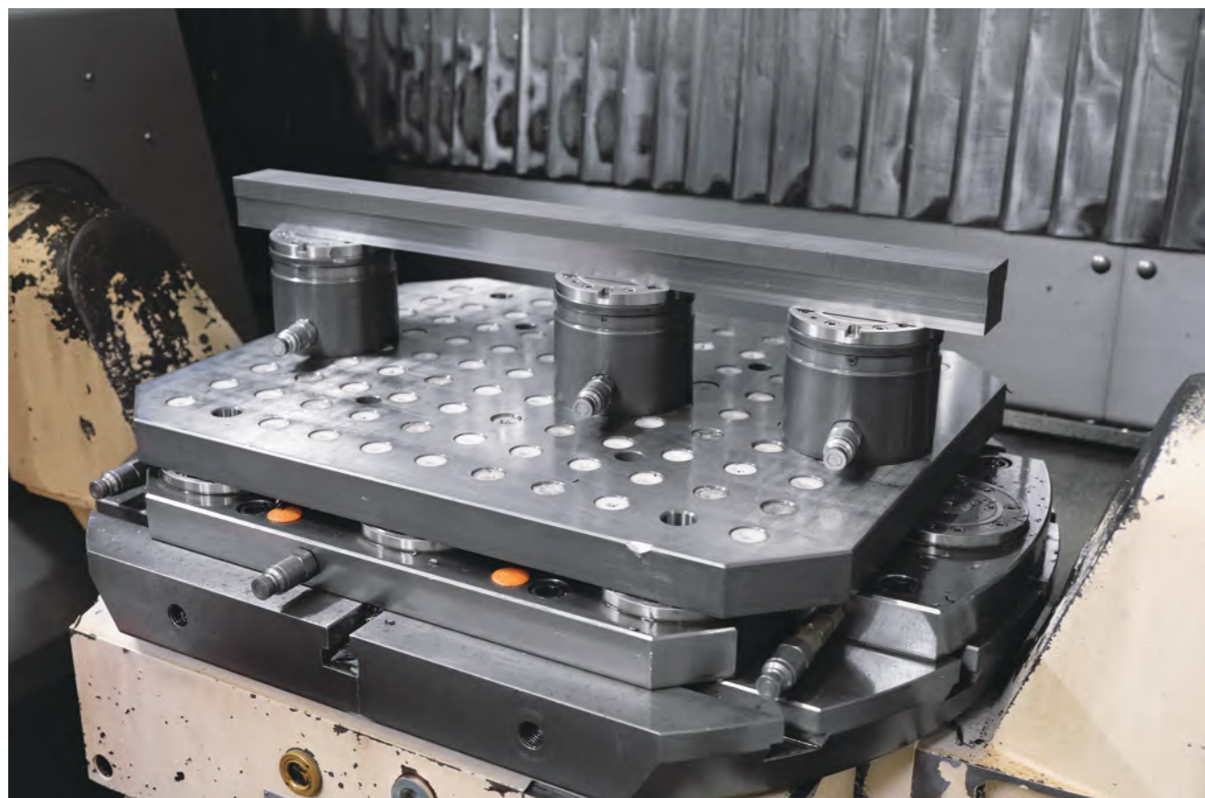
AMF零点定位系统实现五面加工
