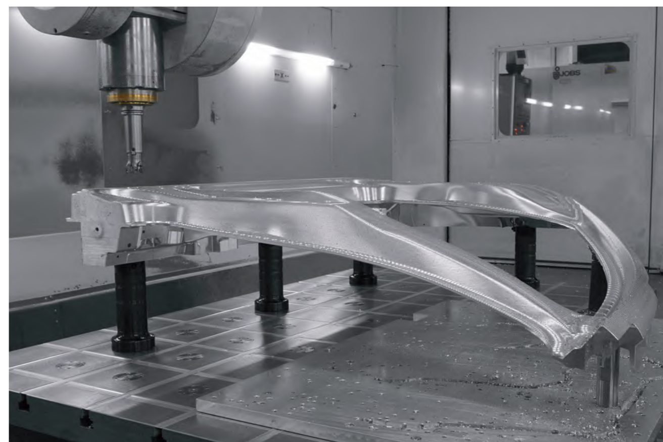
大型复杂铝制组件，使用零点定位系统可实现灵活装夹。
