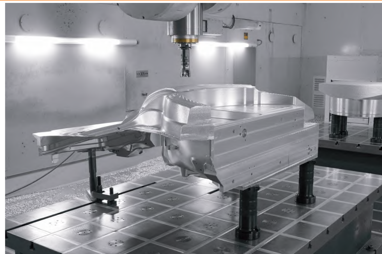
大型复杂铝制组件，使用零点定位系统可实现灵活装夹。
