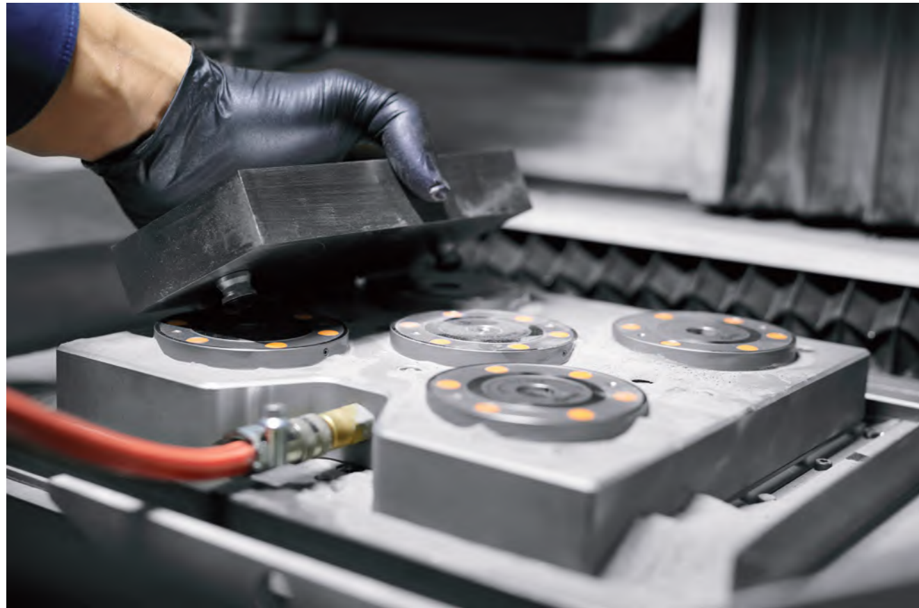
AMF零点定位系统在增材制造（3D打印）中的使用。 5单元零点定位基板在混合机器上快速更换托板。（SLS/HSM）
